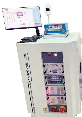
自研自製原子層蝕刻技術為清華大學客製化打造 4 吋原子層蝕刻 / 沉積系統
