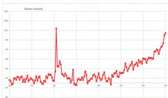
左圖： \text{WS}_2 之拉曼臨場檢測光譜量測圖；右圖： \text{WS}_2 之 In-plane XRD 繞射圖。
