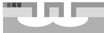
圖 4.34 以 SU-8 光阻作為結構層之梳狀微致動器製作流程。
