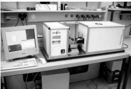
圖 4.203 由 EPFL 發展出的紫外光 DMD 微雷射光合高分子成形機器<sup>(245)</sup>。
