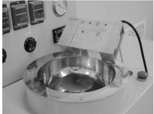
圖 4.188 使用紅外線加熱器做為明膠薄膜旋塗時的輔助工具。
