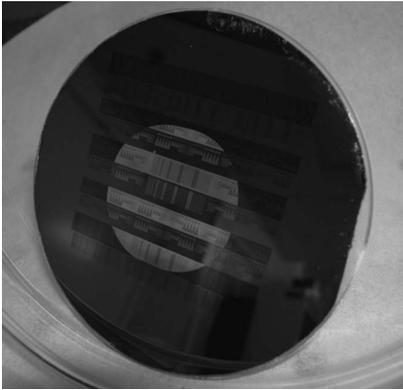
圖 4.7 典型的 X 光光罩，其中吸收體材料為鎢，鼓膜為氮化矽，框架為 Pyrex 玻璃。
