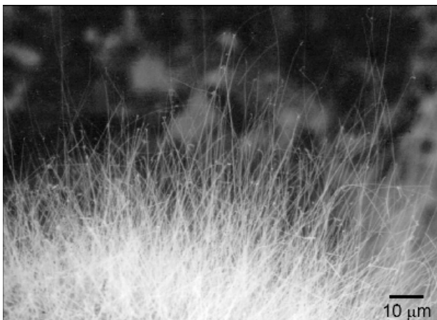
圖 11. 氮化鎵奈米線的 SEM 影像。平均直徑為 20 - 50 nm。 (22)
