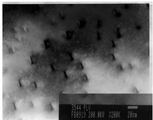
圖 5. InAs/GaAs 自組式量子點之 TEM 平面觀測圖。
