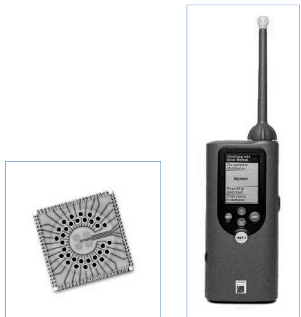
圖 13. 新發展成功的手提式電子鼻儀器 (由美國 Cyrano 公司生產，左圖為其內部之 conducting polymer sensor)。
