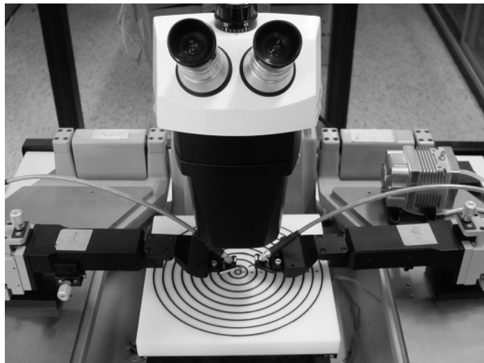
圖 2. 共平面波導探針量測系統外觀。
