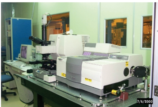
圖 10. 所示為紅外光束線實驗站購自美國 Nicolet 公司所生產製造之 Continuum FTIR 紅外顯微鏡與其 Magna 860 FTIR 光譜儀光學平台 (optical bench)。
