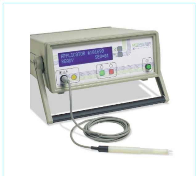
圖 7. 手術型 in-vivo electroporation 設備，脈衝產生器及侵入式針狀電極 (from Genetronics)。
