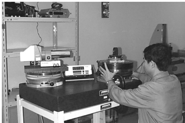
圖 5. 電子式自準直儀校正精密分度盤。
