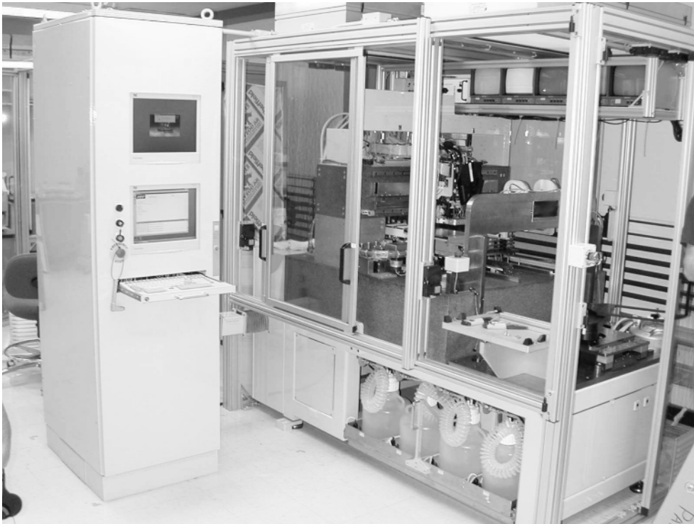
圖 2. 全自動具有電腦監控系統的晶片製造機。
