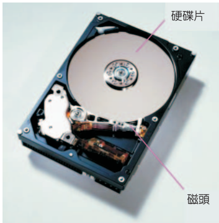
圖 1. 硬碟機的基本結構。
