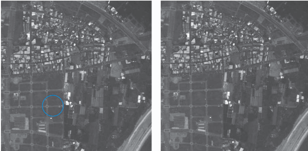
圖 12. 修正前與修正後機載測 試影像，圈圈內可看見 地面反射板及十字標。
