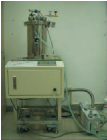
圖 12. 化學氣相沉積系統。
