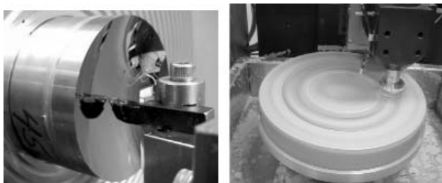
圖 2.(a) 鑽石車削金屬非球面鏡面 ( http://www.fresneltech.com/tooling.html )，(b) 精儀中心電腦輔助拋光系統非球面鏡片拋光製作。
