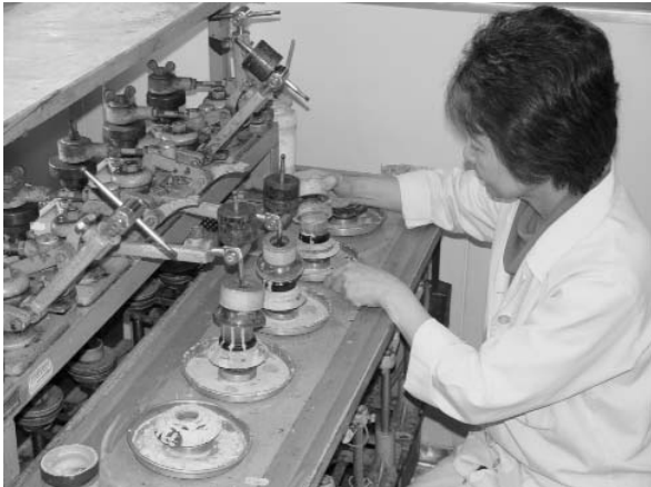
圖 3. 精儀中心球面鏡傳統拋光製作。
