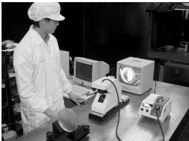
圖 7. 精儀中心數位取像刀口儀檢測系統。
