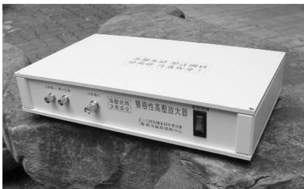
圖 10. 雙極性可調 1800 V pp 高壓輸出放大器。
