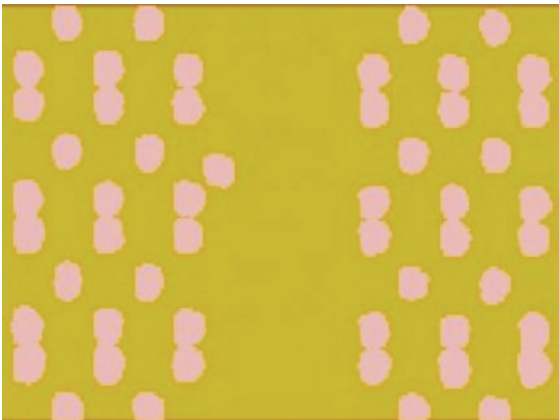
圖 11. 試片偏壓 1 V 時，經由 C-AFM 掃描後在故障位元附近所取得電流成像。
