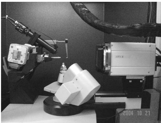
圖 1. 配備在 X8 APEX 系統上最新型的 CCD X 光二維偵測器 APEX II。
