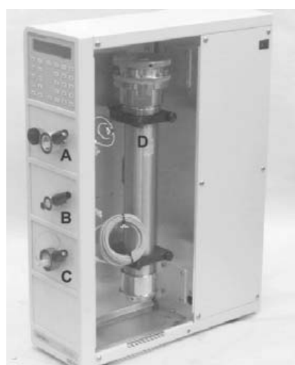
圖 10. 分析放大系統進樣閥設計。
