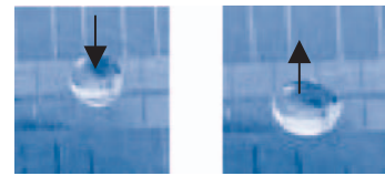
圖 8. 實際液珠推動結果。左圖：上排電極接地；右圖：下排電極接地。
