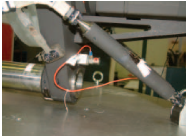
圖 4. 安裝於主結構板下端之加速規。
