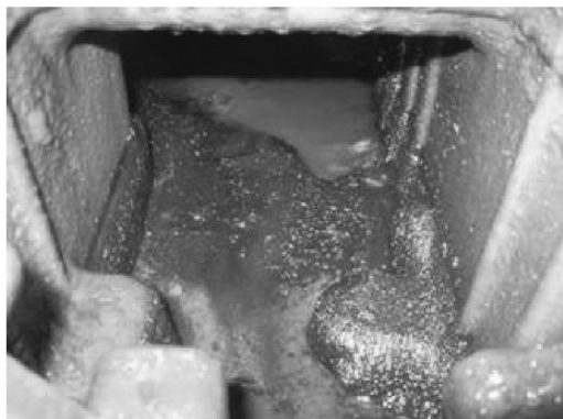
圖 11. 層壓製程所使用幫浦油之劣化。
