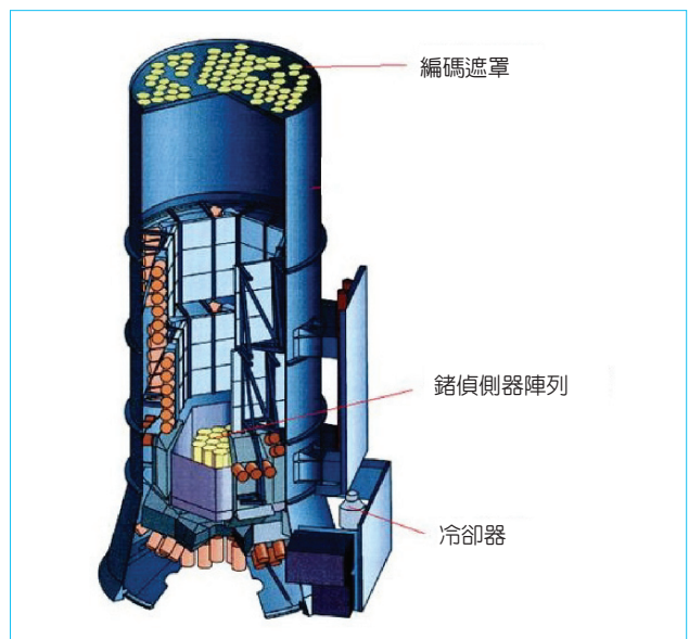
圖 4. 歐洲太空總署的國際 \gamma 射線天文觀測衛星上的光譜儀。本圖內容取自 SPI 的網站 ( http://integral.esac.esa.int/integ_payload_spectro.html )。
