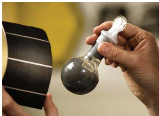
圖 1. NanoSolar 銅銦硒薄膜太陽能電池印刷噴塗技術 (資料來源：Nanosolar)。
