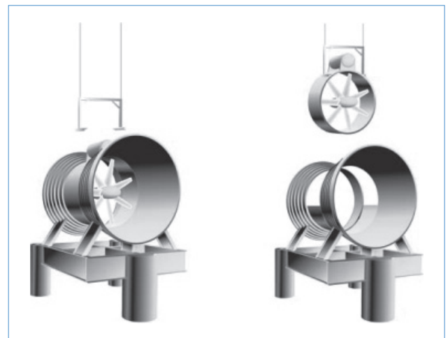
圖 10. RTT 2000 海流發電機示意圖，渦輪機可與導管分離以便維護。
