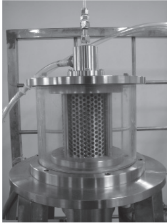
圖 8. 錯流式旋轉填充床。
