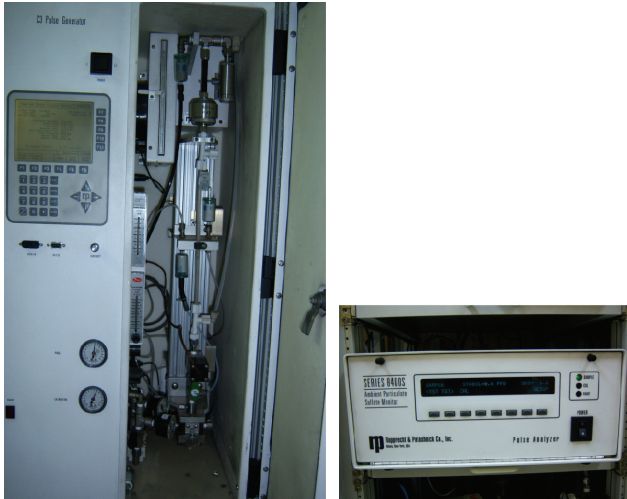
圖 2. R&P 8400S 微粒硫酸鹽連續監測系統。(a) 微粒收集與 \text{SO}_2 氣相轉化單元，(b) \text{SO}_2 氣相分析單元。
