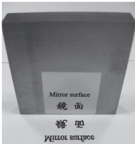
圖 9. 大面積平面拋光結果照像圖。
