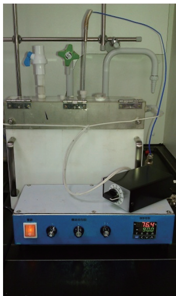
圖 22. 自主設計之 10 \times 10 \text{ cm}^2 CdS 薄膜化學水浴法沉積設備。
