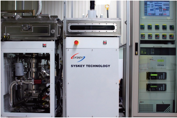
圖 10. 大型硒化爐設備。
