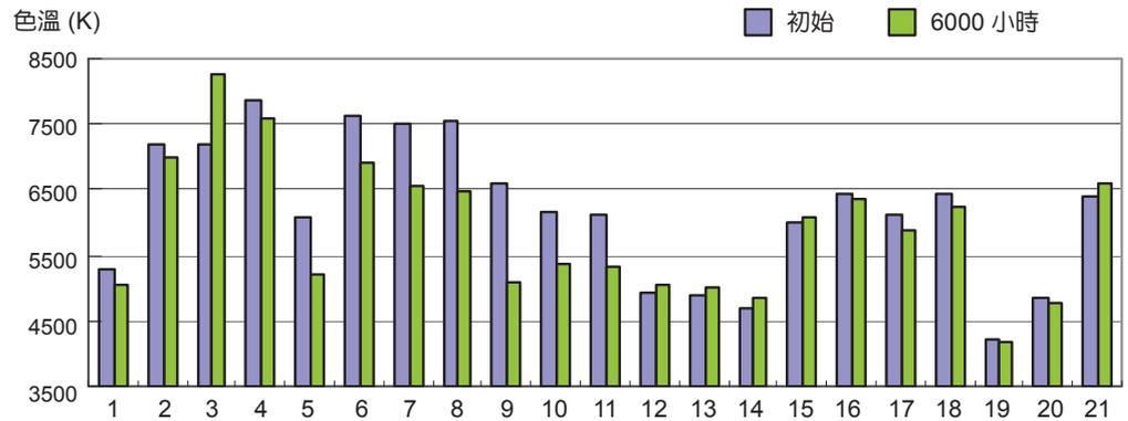
圖 3. LED 路燈 6000 小時光衰減與色溫變化。
