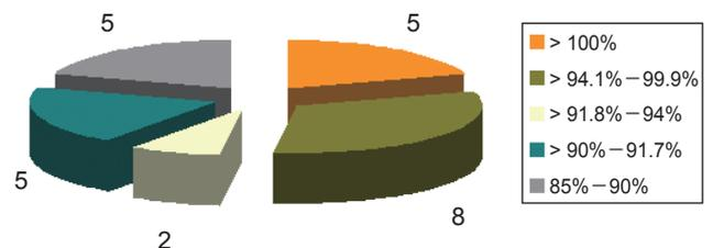
圖 2. 實驗室測試 LED 路燈 6000 小時光通量維持率分布。
