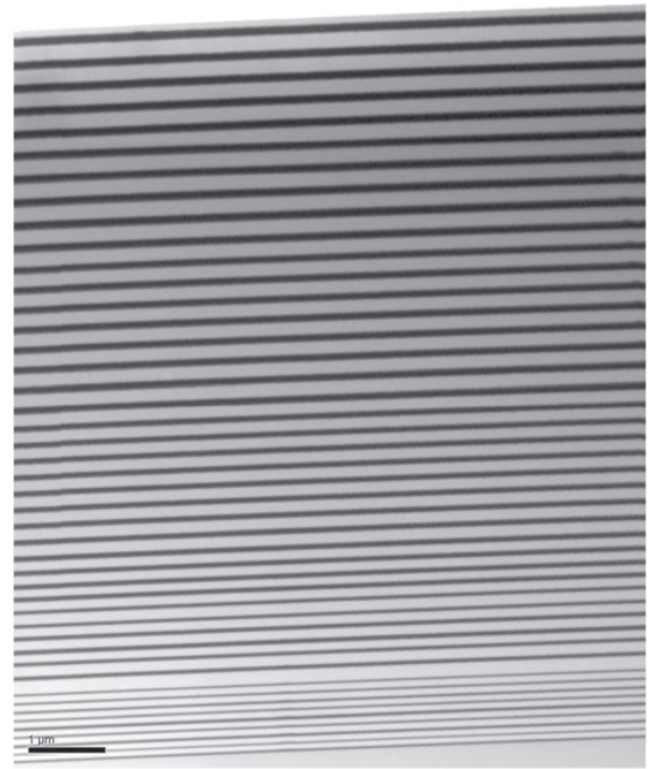
圖 5. 藍光濾光片 (B1) 之穿透式電子顯微鏡截面顯微結構，其包含三個短波通及一個長波通濾光鏡膜堆，以抑制 300–1100 nm 波段內之雜光；圖中顯示高、低折射率材料交互堆疊，濾光鏡總層數為 92 層。
