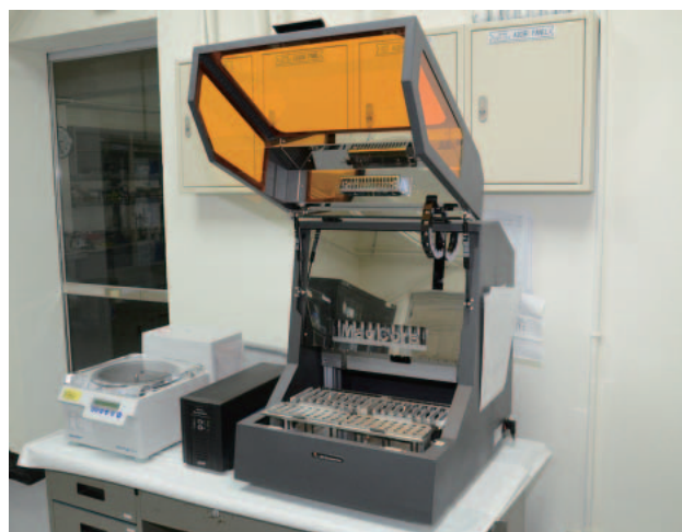
圖 3. 核酸自動化萃取儀外觀 (磁珠 DNA 萃取法原理)。
