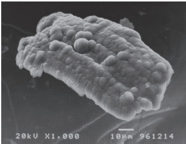
圖 10. 彈頭擊中透明壓克力板所生具熔融狀特徵的碎屑。
