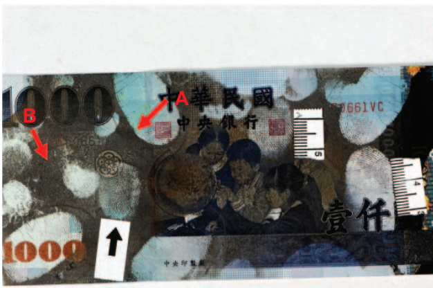
圖 13. 手指接觸鈔票，使用真空金屬鍍膜法顯現全景。
