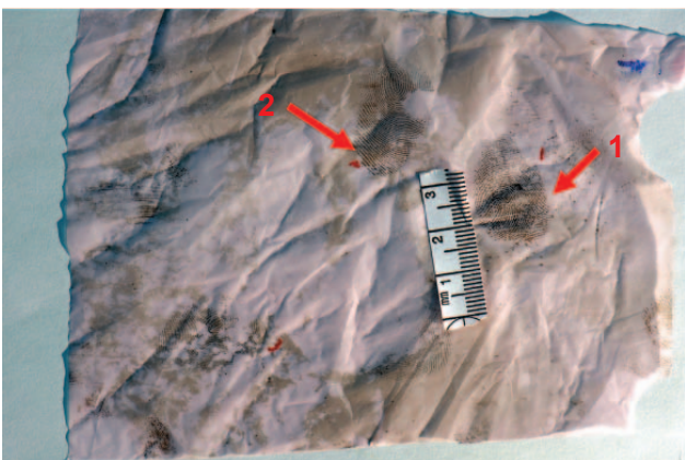
圖 8. 圖 7 塑膠袋先使用氰丙烯酸酯法，再續行使用真空金屬鍍膜法將潛伏指紋顯現。
