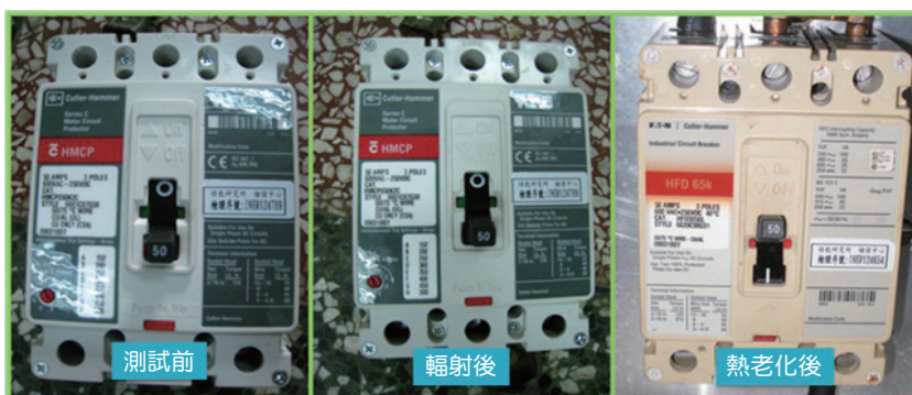
圖 7. 無熔絲斷路器測試前、輻射與熱老化後外觀比較圖。
