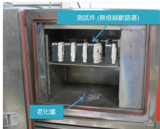
圖 6. 無熔絲斷路器熱老化測試照片。
