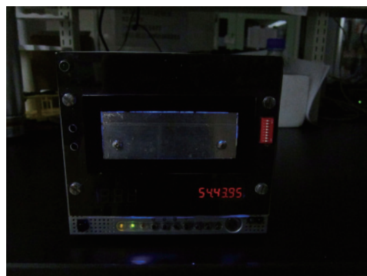
圖 6. 基因橡皮擦之光學輔助系統。圖中紅色數字代表曝照於 460 nm 藍色可見光之時間(分鐘)，由面板可觀察到此系統確實可發出藍色可見光。
