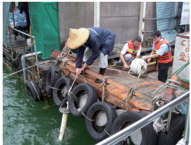
圖 19. 船載核種偵查儀實施水污染調查。
