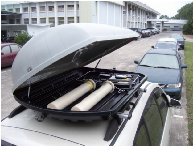
圖 20. 車載核種偵查儀實施地面汙染調查。
