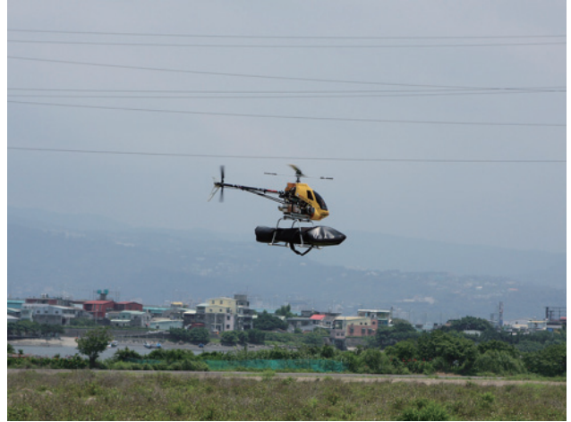
圖 21. 遙控直昇機載運核種偵查儀實施地面汙染調查。
