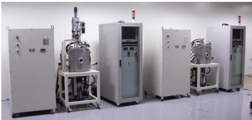
圖 2. 電阻式加熱浮區法及助溶劑生長法。
