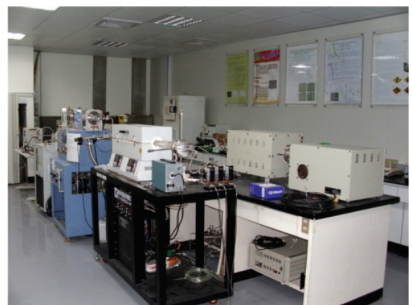
圖 4. 化學汽相沉積及紅外線高溫生長爐。
