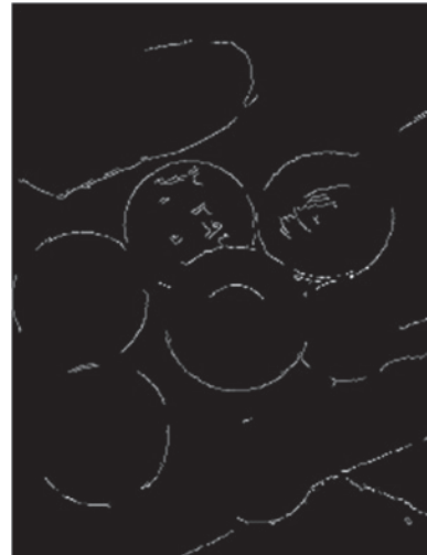
圖 9. 以 A1 的 a 圖像 (不作量化處理) 作 Canny 邊緣偵測的結果圖。
