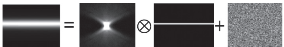
圖 8. 線型彩色共焦反射光強摺積示意圖。
