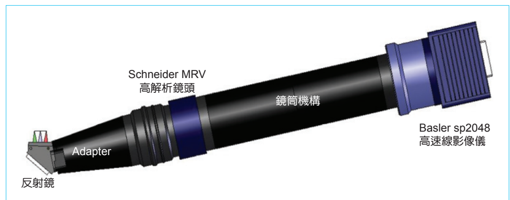
圖 4. 線掃描光機裝置的外型 構形。
