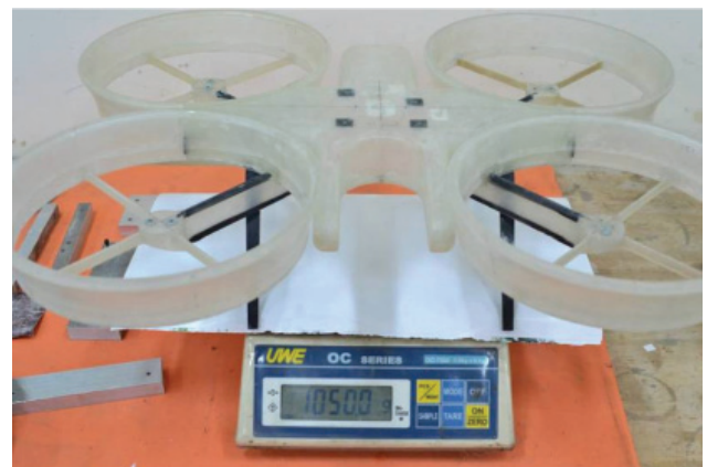
圖 6. 以玻璃纖維製作完成之載具成品。
