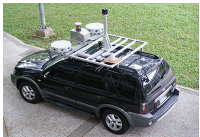
圖 6. 成功大學發展之車載移動測繪系統。
