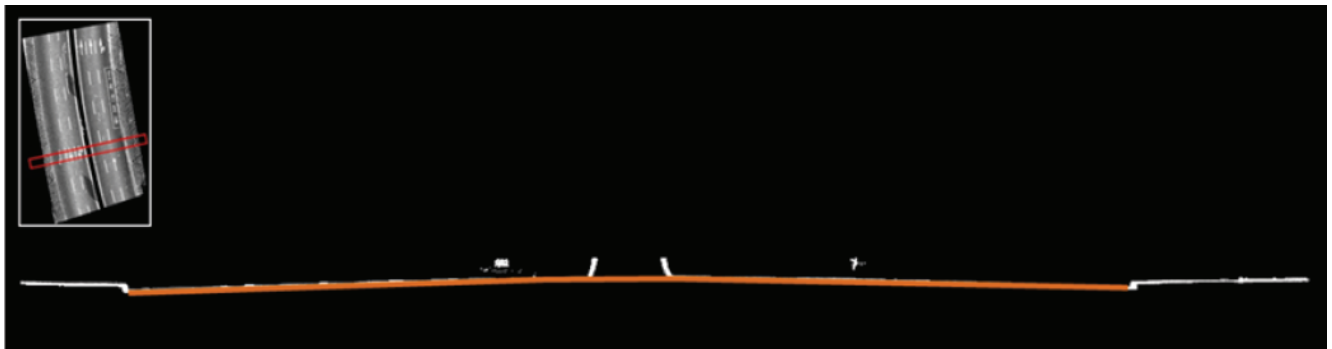
圖 11. 網格內點雲投影與路面擬合示意圖。
