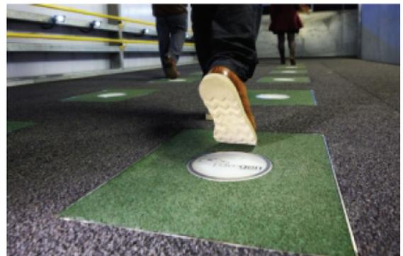
圖 6. Pavegen 公司所研發之發電地磚實景圖<sup>(12)</sup>。
