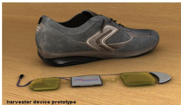
圖 8. InStepNanoPower 公司研發之發電鞋內部元件<sup>(14)</sup>。
