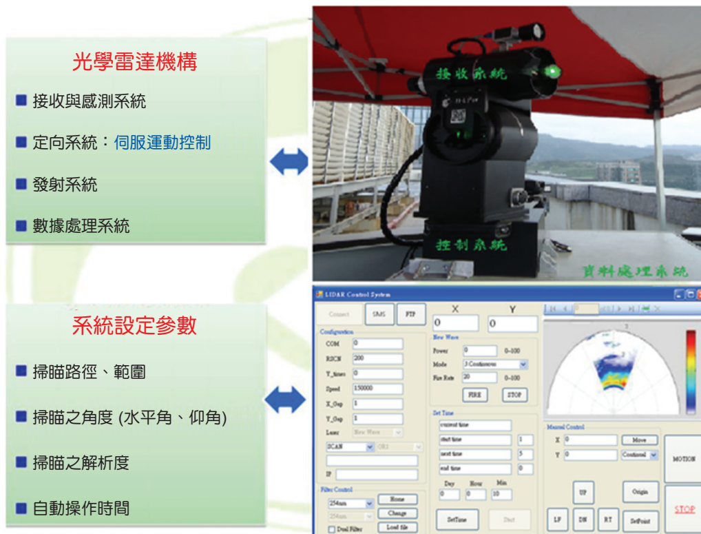
圖 1. 光達系統架構與人機操作介面。
