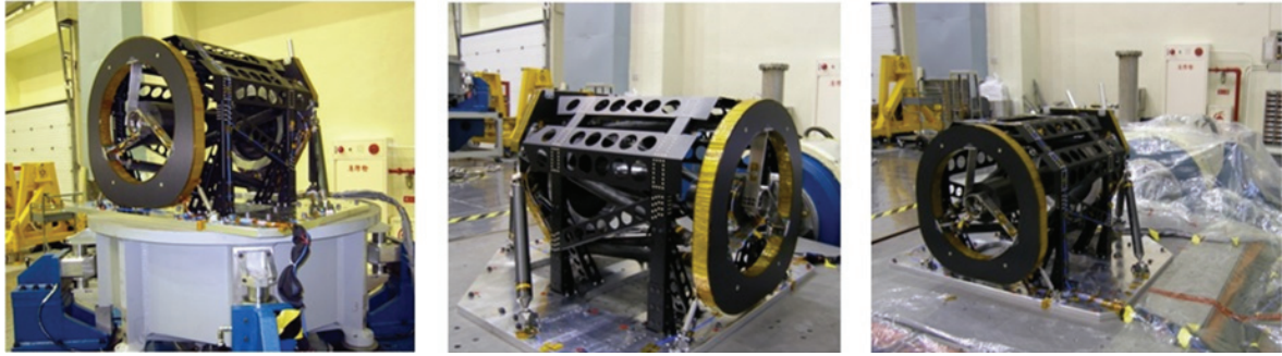
圖 5. 結構飛行體的驗證過程 (由左至右分別為 X 軸向，Y 軸向，Z 軸向之準靜態振動測試構型)。
