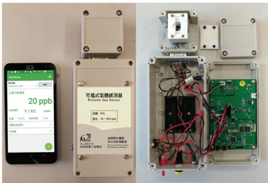
圖 5. 手機操控可攜式氣體感測器，上方為感測模組，內有感測晶片及 UV LED，下方為控制電路、藍芽通訊模組及電池。
