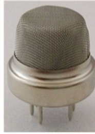
(2) 觸媒燃燒式氣體感測器 (尺寸：Φ19 × 24 mm)
