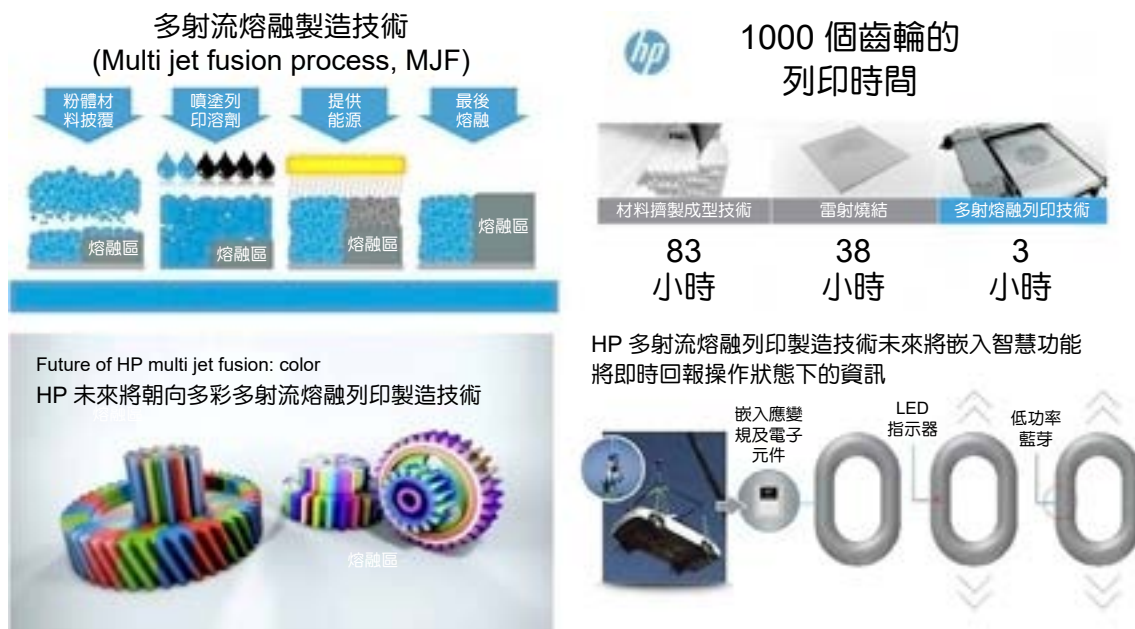
圖 10. 惠普 (HP) 多射流熔融 (multi jet fusion, MJF) 數位積層製造技術。
