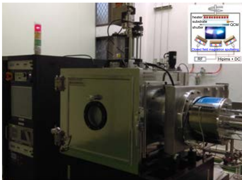
圖 11. 封閉式高能磁控濺鍍系統，中華民國發明專利 I615494 (18) 。
