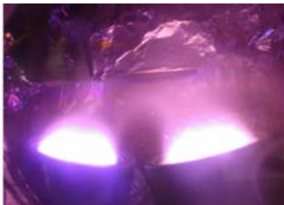
圖 8. 儀科中心所開發封閉式電漿濺鍍系統。
