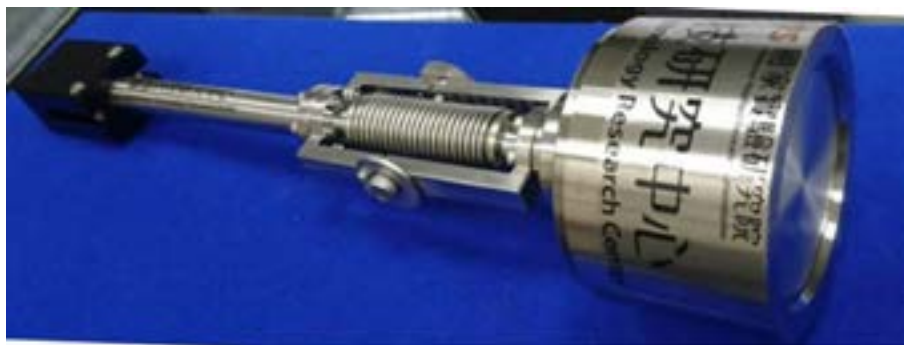
圖 7.3 吋非平衡圓形磁控濺鍍槍。
