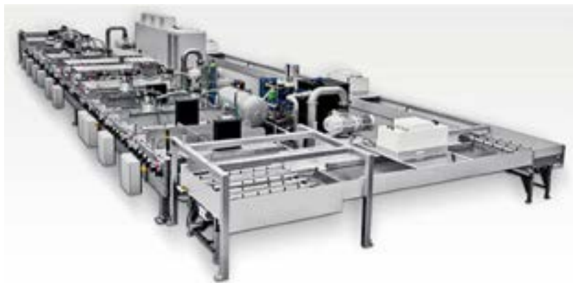
圖 3. Leybold 公司連續式 (in line) 濺鍍設備。
